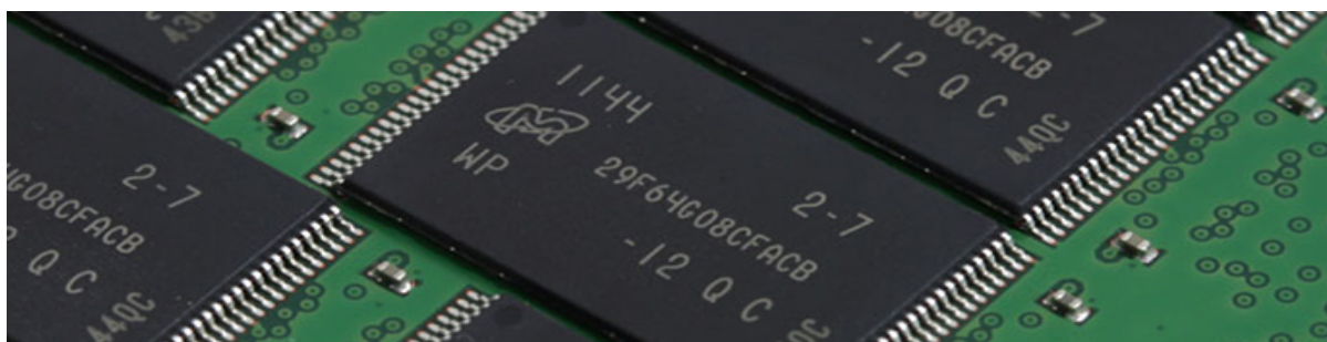
Рис 3. NAND-микросхемы флэш-памяти Micron 29F64Go8CFACB на плате накопителя
