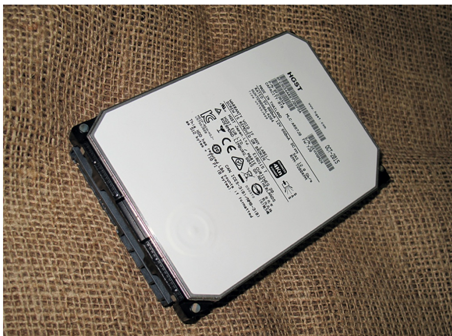
Рис 1. Магнитный диск HGST с интерфейсом SAS емкостью 8 Тб, модель HUH728080AL4204
