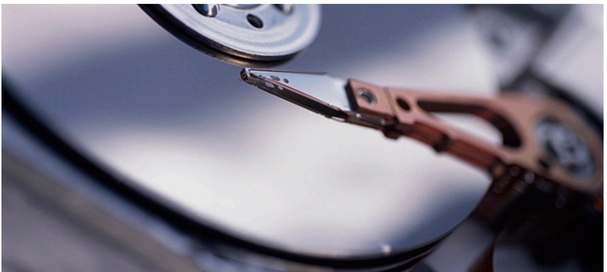
Рис 2. Блок головок парит над поверхностью магнитной пластины, защищенный гелиевой подушкой
