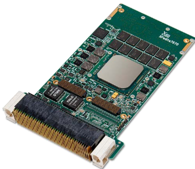
Рис. 2. Одноплатный компьютер на базе Intel Xeon-D от компании X-es , анонсированный 18 марта с.г., используется без активного охлаждения
