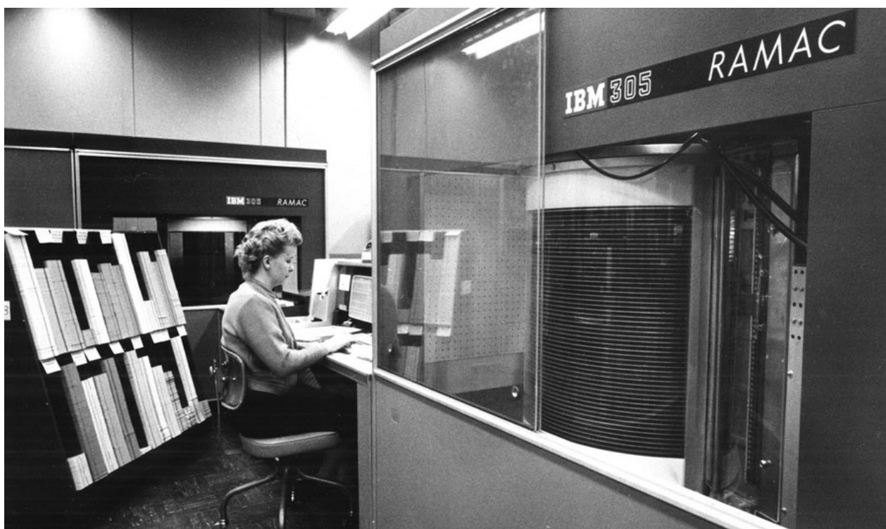
Рис 2. Система хранения данных RAMAC-305 на жестких магнитных дисках
