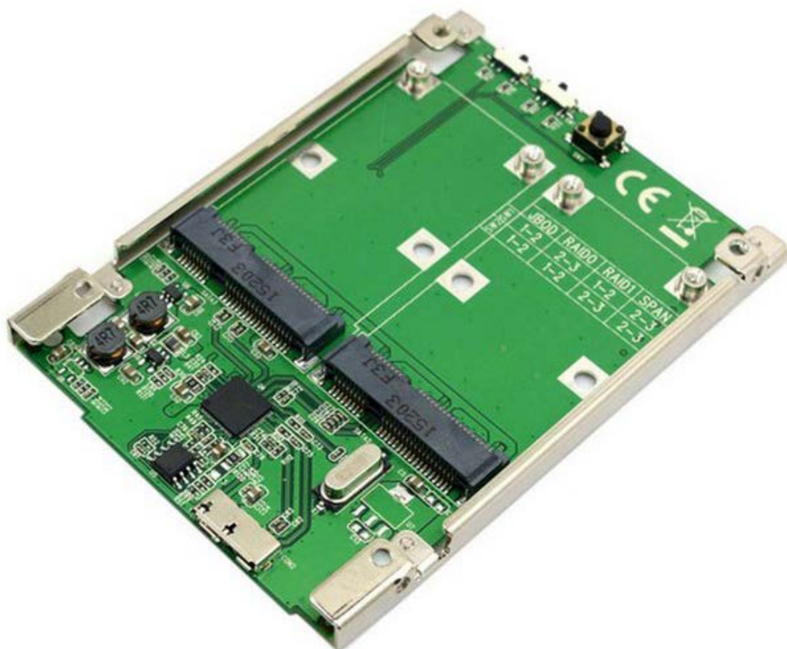
Рис.1 Плата USB RAID и контроллер ASM1352R: режимы RAID устанавливаются переключателями, согласно нанесенной таблице
