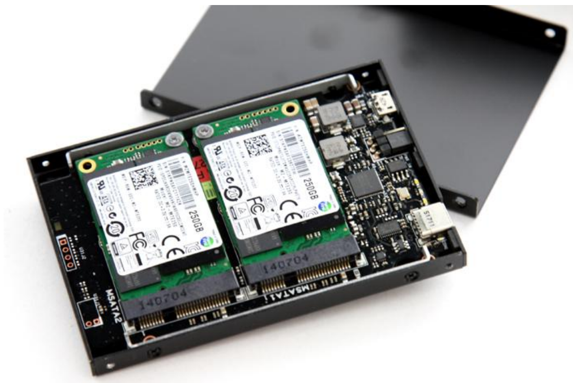
Рис 3. Еще один вариант реализации RAID-массива, сформированного на USB-шине с помощью контроллера ASM1352R от ASMedia Technology
