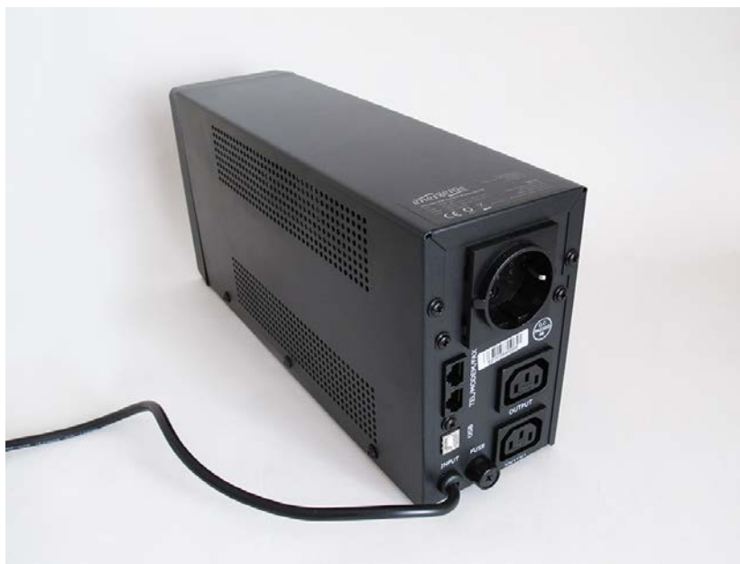
Рис 2. Интерфейсная панель источника бесперебойного питания Energenie EG-UPS-032
