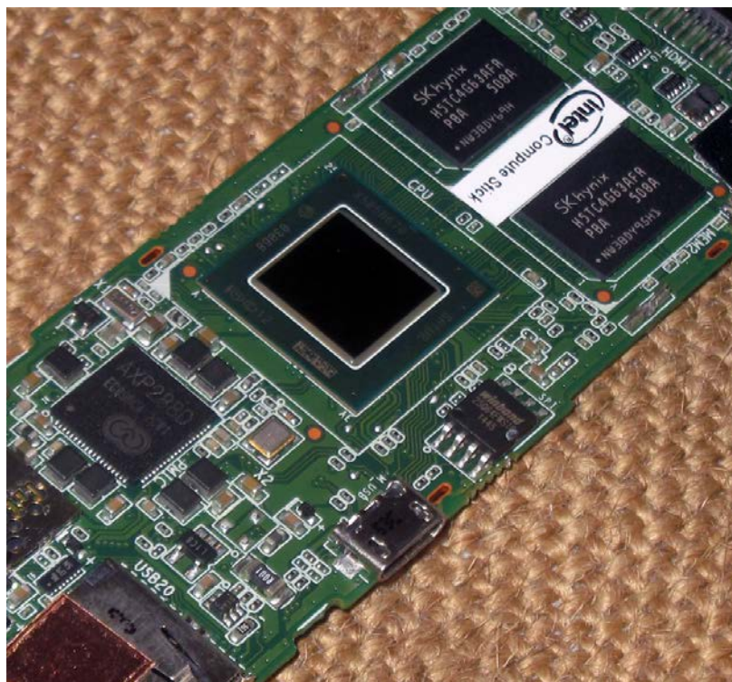
Рис 1. Микросхема флеш-памяти W25Q64FV на плате Intel Compute Stick
